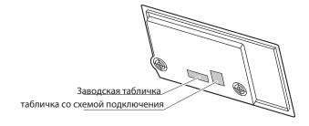
Входящую в комплект поставки вторую заводскую табличку следует наклеить в доступном месте за передней панелью расположенного ниже мебельного элемента.
